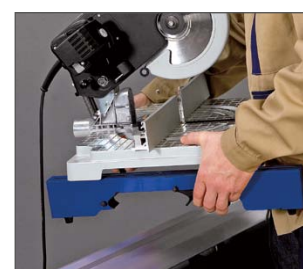
▶ Rychloupínací systém umožňuje variabilní a rychlé přestavení pracoviště.
