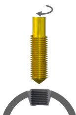
Beztržkové vytvoření závitu
