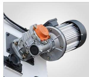
▶ Dvě rychlosti pilového pásu pomocí dvourychlostního motoru 400 V
