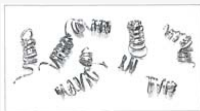
Volně navíjené třísky – správné řezné podmínky
