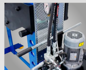
Ovládání hydrauliky lisu.
