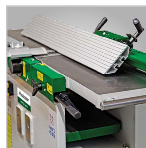
▶ Nastavení úběru třísky pomocí páky
