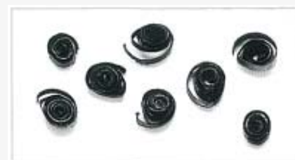
Tlusté, těžké nebo modré třísky – příliš vysoká rychlost řezání
