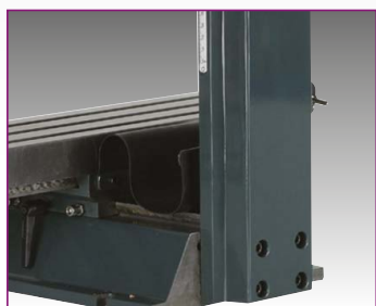
Sloup stranově přestavitelný o \pm 30 mm
