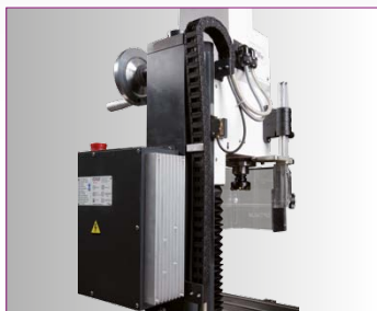
Energetický řetěz pro šetrné vedení kabelů.
