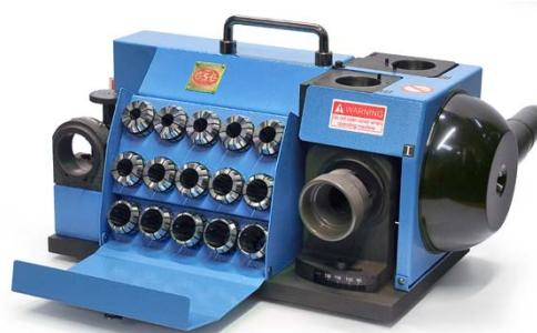
GS-34 – bruska na spirálové vrtáky pravé \varnothing 8 – 34 mm , s přípojkou pro odsávání. S adaptérem a dodatečnou sadou kleštin (volitelné příslušenství) možno brousit vrtáky již od \varnothing 3 mm.
