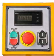
Ovládací pult s digitálním odměřováním
