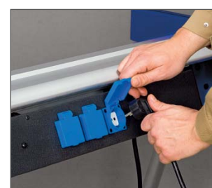
▶ Tři zásuvky 230 V na straně obsluhy.
