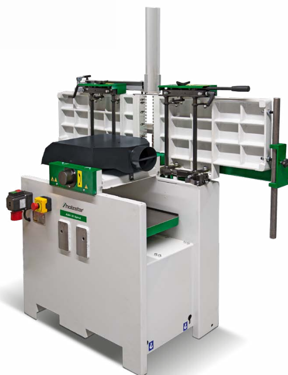
▶ Nastavení úběru třísky pomocí páky
