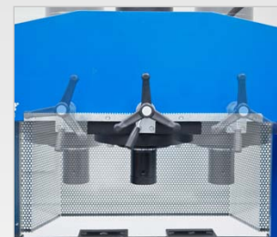
Rychlý a snadný posuv válce pomocí ručního kola a ozubené tyče
