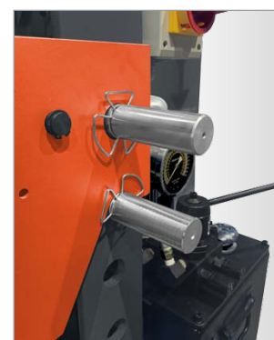
► Důkladná fixace pomocí dvou ocelových tyčí na každé straně lisovacího stolu
